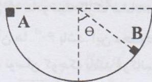
سوال ۹ - مکعب کوچکی به جرم  $m$  از نقطه A بر روی مسیر نیم دایره ای بدون اصطکاکی از حال سکون رها می‌شود. عکس العمل سطح در نقطه B کدام است؟
